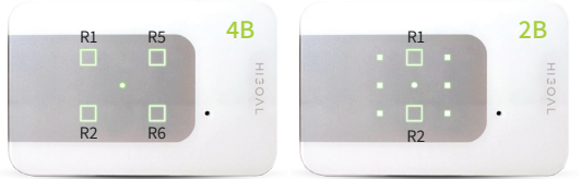
4B מוצאים, 5 אמפר למוצא 4 כניסות מגע יבש 4 במקביל ללחצנים 2B מוצאים, 10 אמפר למוצא 8 כניסות מגע יבש 8 במקביל ללחצנים
